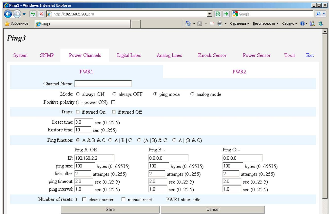
Параметры **Channel Name**, **Mode**, **Positive polarity** и **Traps** общие для всех режимов работы, они описаны в разделе [Общие настройки каналов управления питанием – WEB интерфейс](#) на стр. 26.
