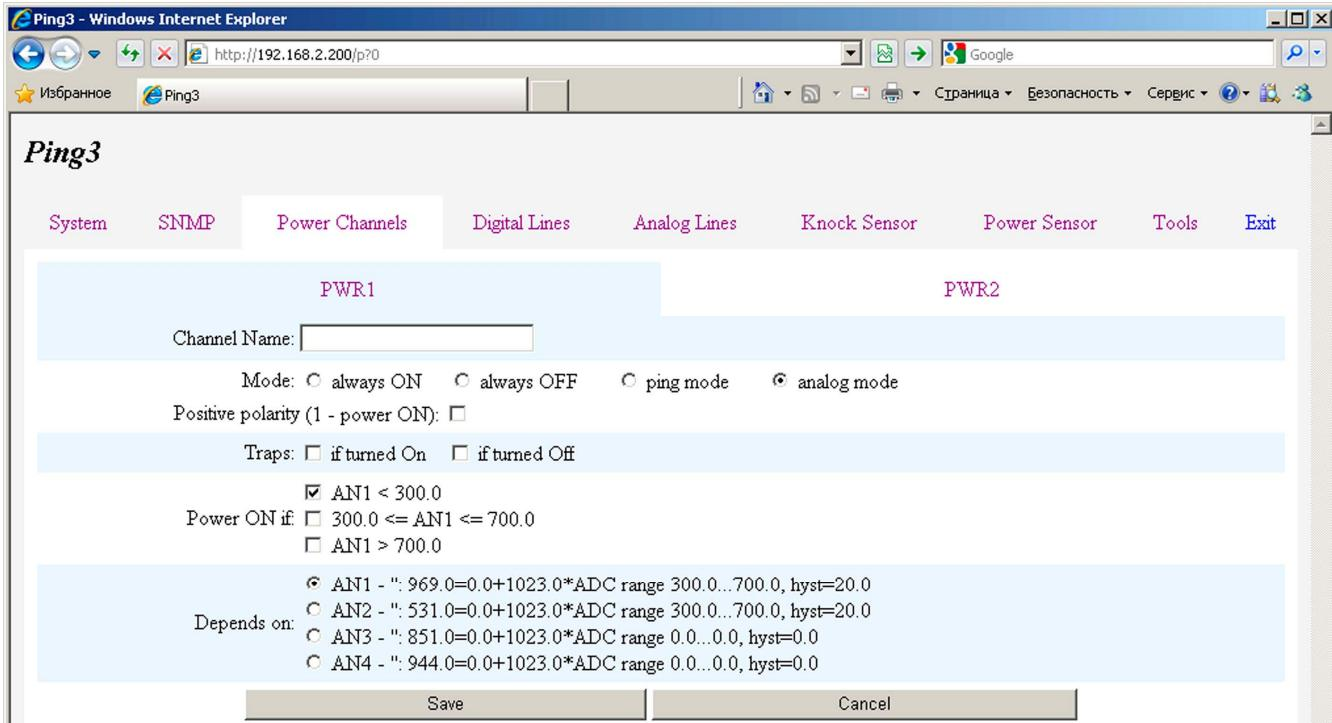
Параметры **Channel Name**, **Mode**, **Positive polarity** и **Traps** общие для всех режимов работы, они описаны в разделе [Общие настройки каналов управления питанием – WEB интерфейс](#) на стр. 26.
