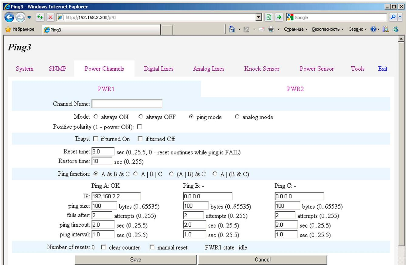
Параметры **Channel Name**, **Mode**, **Positive polarity** и **Traps** общие для всех режимов работы, они описаны в разделе *Общие настройки каналов управления питанием – WEB интерфейс* на стр. 27.
