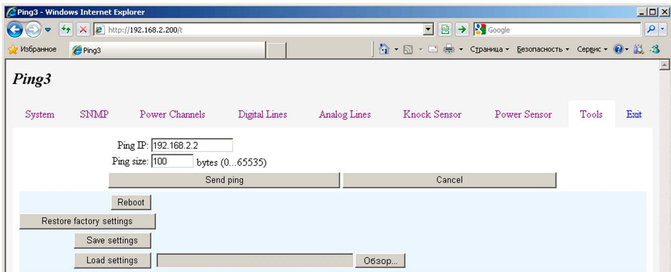
На данной странице доступны следующие функции: [ручная отправка ICMP запросов](#), [перезагрузка устройства](#), [восстановление заводских настроек](#), [сохранение настроек в файл конфигурации](#) и [загрузка из файла](#). Все функции описаны в соответствующих пунктах этой главы.
