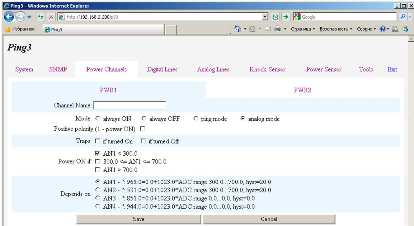
Параметры **Channel Name**, **Mode**, **Positive polarity** и **Traps** общие для всех режимов работы, они описаны в разделе [Общие настройки каналов управления питанием – WEB интерфейс](#) на стр. 27.
