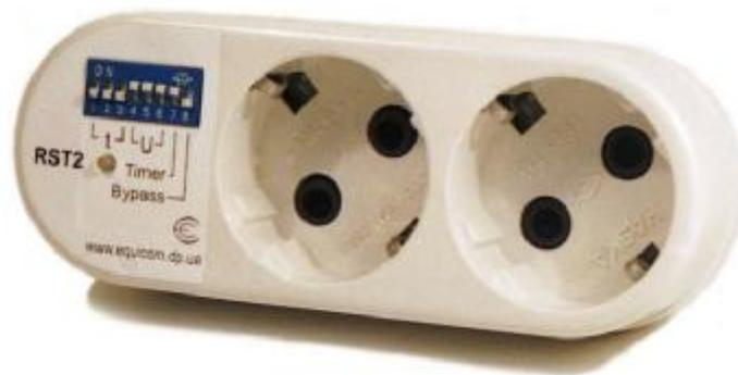
Ребутер объединяет в себе функции таймера сброса (может сбрасывать питание нагрузки через заданные промежутки времени) и супервизора питания (производит сброс после провалов напряжения в сети, а также отключает нагрузку для защиты от перенапряжения, если напряжение питания превысит 255В). Значения временных интервалов и уровни напряжения задаются при помощи внешних переключателей. Режимы работы устройства индицируются двухцветным светодиодом.
